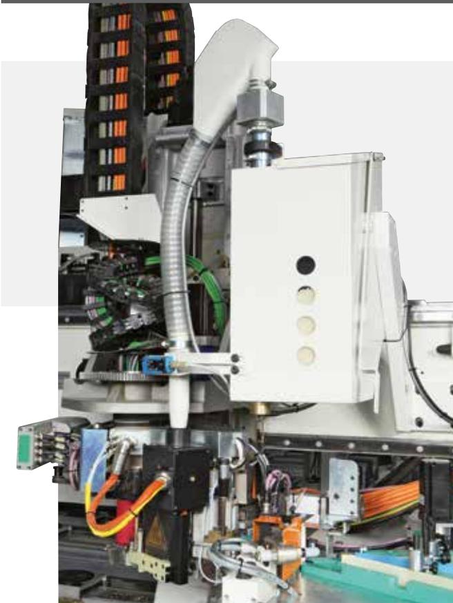
Il caricamento della colla avviene in tempo mascherato nel sistema di alimentazione granuli solidale al gruppo di incollaggio.
