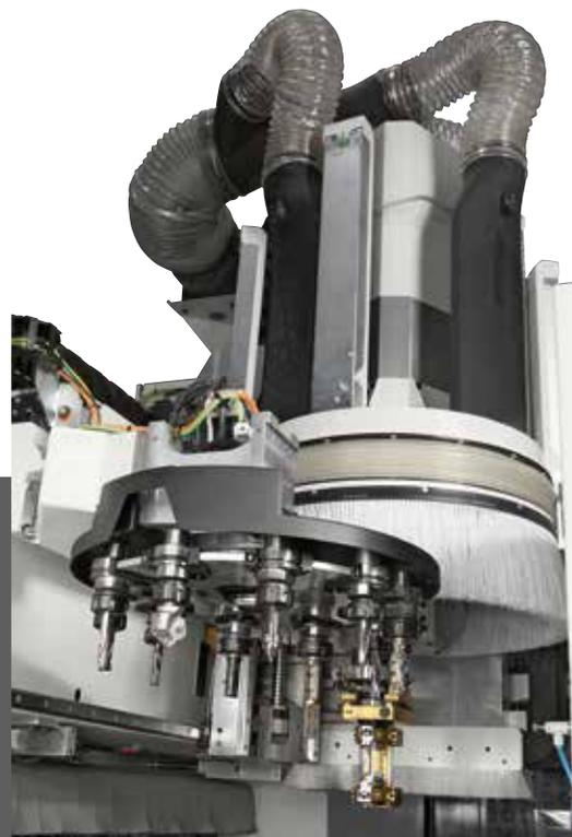
L'unità operatrice 4 assi, con potenze da 11 e 15 kW (S6) montato su un carro indipendente dall'unità di foratura, in grado di svolgere tutte le funzioni di fresatura verticale con utilizzo di teste per la finitura del bordo. Asse C  $\circ/360^\circ$  continuo ed alimentazione utenze pneumatiche per testine finitura bordo.
