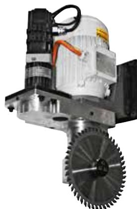
**Gruppo lama** a rotazione indipendente 0-360°, ideale per la sezionatura del pannello o l'**intestatura del bordo on-the-fly.**
