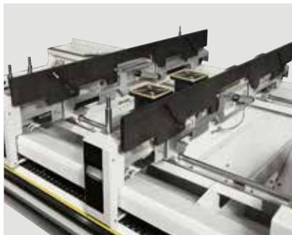
**Dispositivi di aiuto carico** sensorizzati con sollevamento pneumatico agevolano il posizionamento sul piano dei pannelli pesanti.
