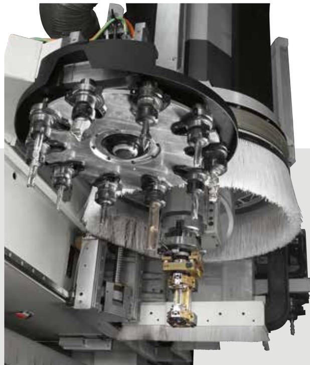
La sostituzione degli utensili è automatica ed avviene in tempo mascherato, mentre l'unità di bordatura è operativa. Questo è possibile grazie ai **magazzini da 10 e 18 posizioni** installati direttamente sulla macchina.
