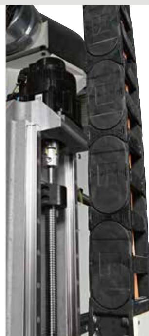
L' **asse Z a controllo numerico** permette di regolare la sporgenza inferiore del bordo rispetto al piano di lavoro, ad esempio per l'utilizzo di bordi parapolvere.
