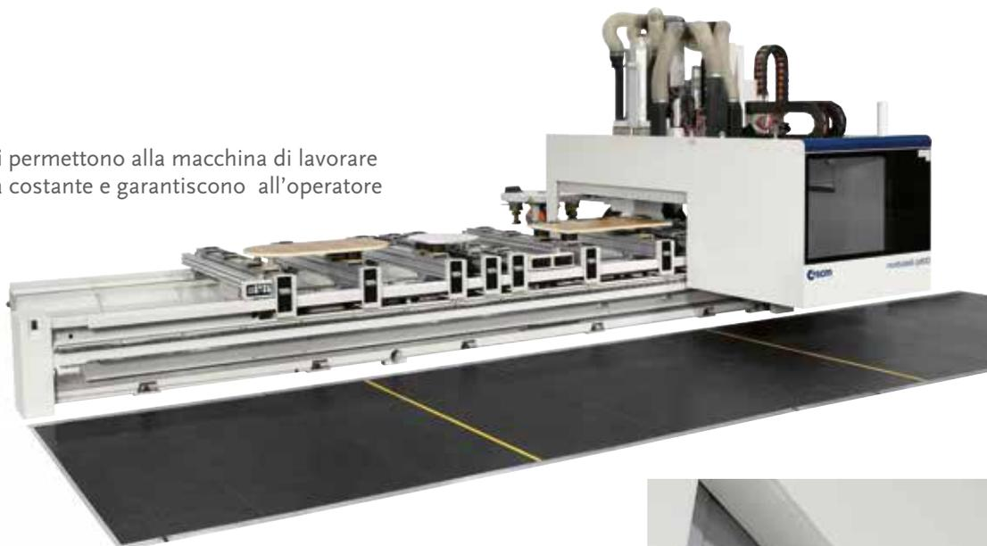
Strati sovrapposti di bandelle laterali a protezione del gruppo operatore, mobili per lavorare a massima velocità e totale sicurezza.
