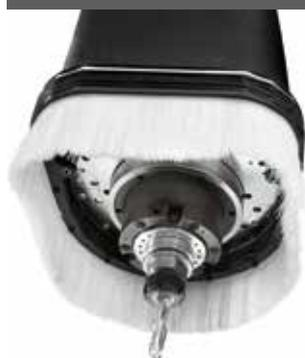
**Elettromandrino** a 3 assi, ottimo per eseguire sagomature del pannello e lavorazioni di antischeggia su pannelli già bordati, **evitando il cambio utensile sul motore principale.**
