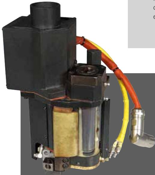
La vasca colla a cambio rapido dall'esclusivo disegno con rullo spalmatore dotato di resistenza integrata garantisce l'uniformità di incollaggio e la durata delle caratteristiche chimiche del collante per la miglior performance del prodotto.
