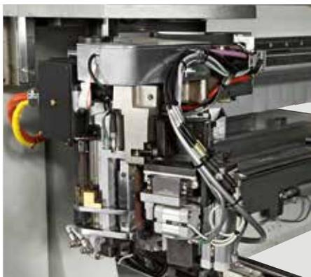
Il nuovo gruppo bordatore con applicazione della colla **direttamente sul bordo** permette di **ridurre il numero degli organi meccanici** necessari alla sua costruzione con conseguente aumento di:
