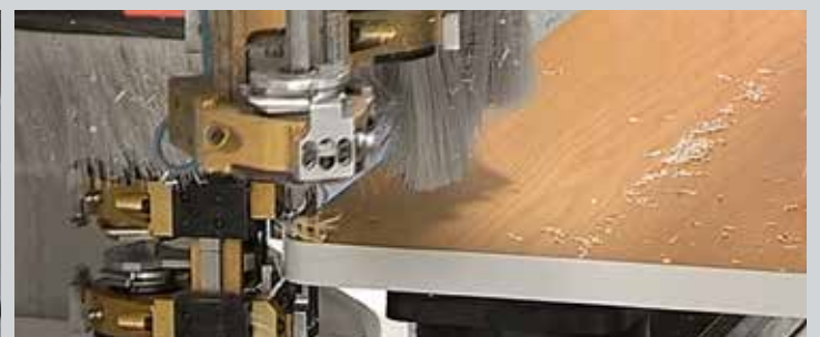
Lavorazione di raschia-bordo.
