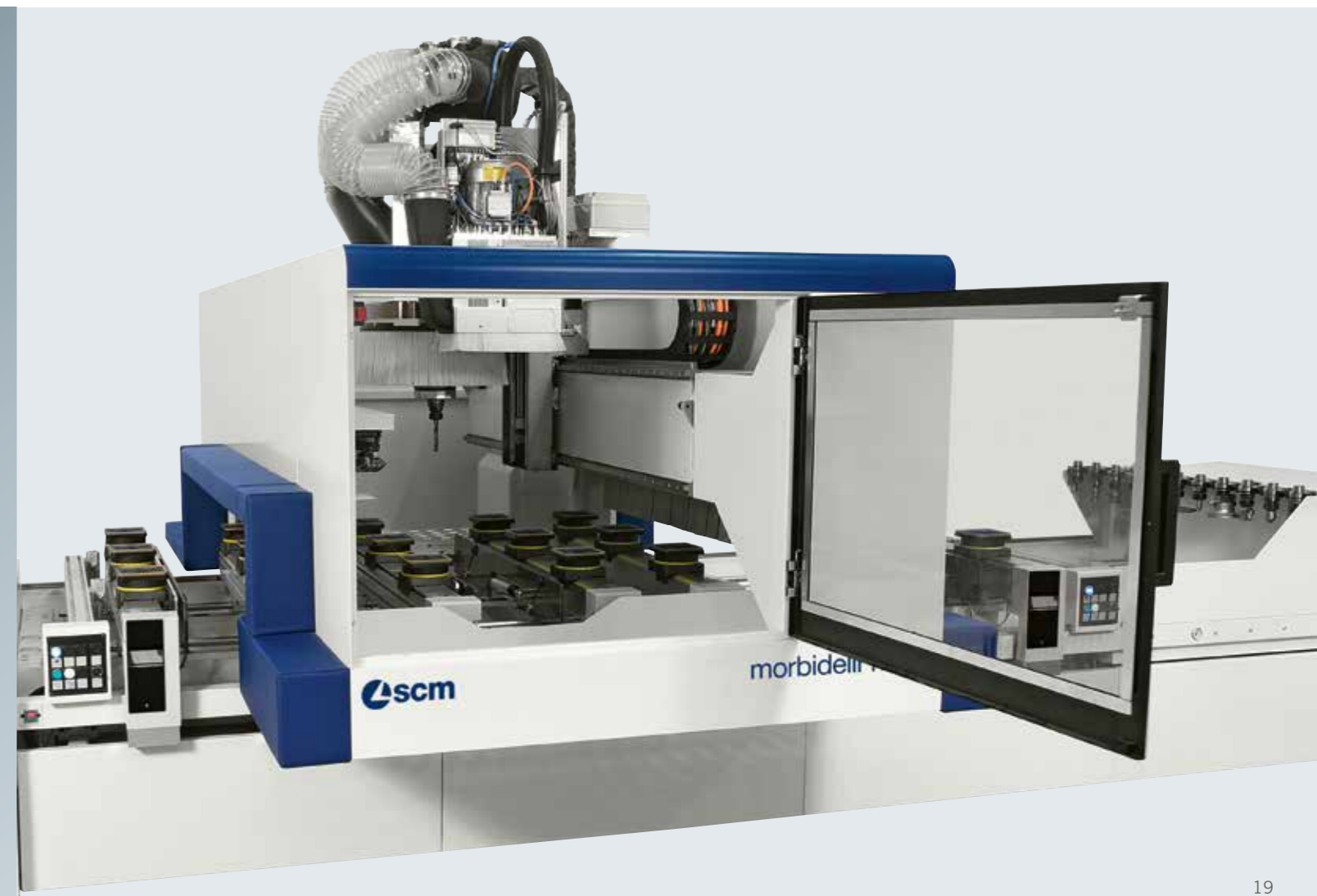
Rapidità ed ergonomia nell'attrezzare e fare manutenzione al gruppo operatore con la pratica apertura anteriore dello sportello.
