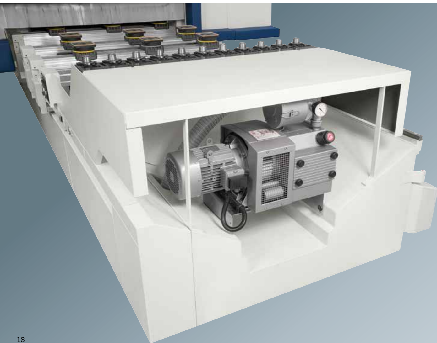
Libero accesso senza ostacoli a terra, catena portacavi e pompa del vuoto posizionate all'interno del basamento macchina.
