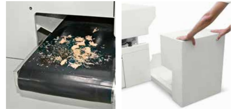
Nessun problema di sfridi con il nastro trasporta trucioli dotato di cappa di aspirazione ed il carrello porta scarti di lavorazione collocato in posizione ergonomica.
