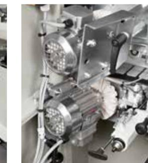
**Grupo intestatore.** Il gruppo è equipaggiato con 1 motore ad alta frequenza per il taglio del bordo anteriore e posteriore a 90°.
