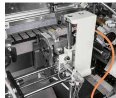
**Grupo encolador.** El grupo está dotado de rodillos con resistencia interior que mantiene constante la temperatura y cizalla para cantos hasta 3 mm. El calderín de cola en teflón permite de reducir el tiempo de trabajo gracias al cambio rápido de la cola. Depósito de cola de repuesto para el calentamiento del canto del panel disponible bajo demanda.
