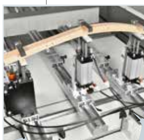
Piano di lavoro a barre configurabile con attrezzature di bloccaggio pezzo Combi, Jig free e CSR.
