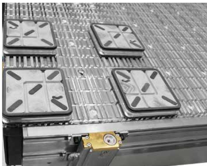
Su tutta la superficie del piano sono presenti scanalature a T che consentono di fissare rigidamente eventuali contro-sagome e attrezzature di fissaggio non fornite da SCM. È possibile configurare il piano di lavoro con innumerevoli tipi di ventose, aggiungendole o rimuovendole agevolmente, in funzione di tipologia e geometria dei pezzi da lavorare.
